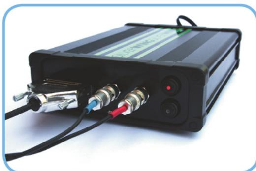
Сканер легко соединяется с УЗК модулем и компьютером посредством простого интерфейсного кабеля, обеспечивая полный сбор необходимых данных.
