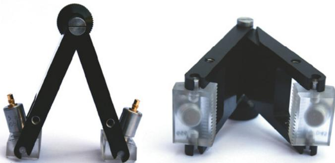
ToFD lite – (Тоффд лайт) это недорогой портативный TOFD сканер с возможностью построения D-скана. ToFD Lite разработана для того, чтобы можно было обеспечить документирование и сбор данных проверки качества стыкового сварного шва, фактически избавляя от необходимости рентгеновского контроля.
